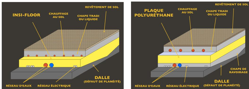
L'isolant thermique et acoustique INSI-FLOOR ne contient ni CFC, ni HCFC. Il est expansé aux HFC lui conférant ses excellentes propriétés thermiques.
